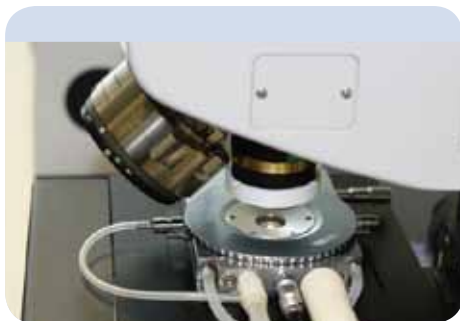
为了研究从-196 – 600\text{ }^{\circ}\text{C} 间某些温度点的显微谱图变化，可以使用Linkam THM600 冷热台，该样品台可以通过OPUS软件进行控温。
