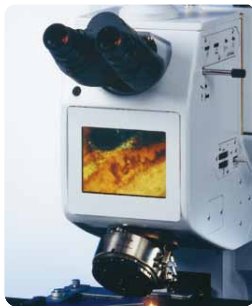
HYPERION上集成的LCD显示屏使定位样品和识别待测区域变得更加方便
